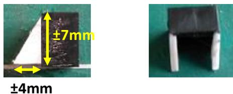
Pour faciliter la mise en place du boîtier Caméra, il est possible de déconnecter le module optique de la carte électronique (**procéder minutieusement, les deux éléments sont fragiles**)
