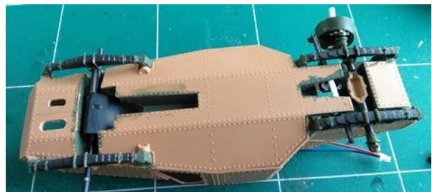
Couper l'arbre moteur du Renvoi d'angle à la bonne longueur ( $\pm 20\text{mm}$ ). De même, couper le tube renfort collé sur chaque roue arrière de façon à ce qu'il vienne en contact avec le boîtier du Renvoi d'angle et que la roue affleure l'arbre moteur du modèle ( $\pm 14\text{mm}$ ). Percer les roues dans l'axe de façon à permettre un meilleur séchage de la colle lors de la fixation des roues sur les arbres moteurs du Renvoi d'angle
