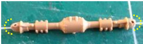
En insérant un axe (ici le foret), vérifier le débattement angulaire de la roue interne par rapport à l'arbre moteur.
