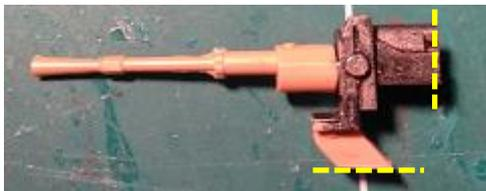
Positionner le Servo sur la base de la tourelle (en appui sur la plaque d'entraînement du Moteur L)
