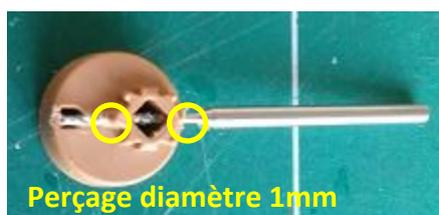
Engager l'arbre moteur avant dans son logement et contre-percer (diamètre 1mm)
