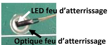
Positionner et coller (colle cyanoacrylate) les LED sur les optiques de feux d'atterrissage.
