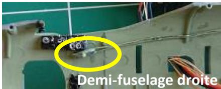
Positionner les LED en faisant passer les câbles le long du fuselage et les coller.
