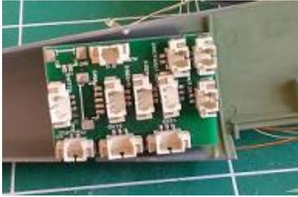
Positionner le module électronique dans le fuselage.
