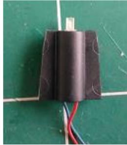
Couper les oreilles de fixation du Moteur S aux dimensions requise pour pouvoir le coller dans la nacelle.
