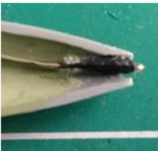
Sur un demi-fuselage, positionner et coller la LED du feu de navigation arrière.
