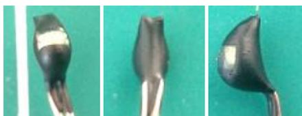
Afin d'éviter une trop forte diffusion de la lumière (et/ou une trop forte luminosité), peindre la goutte de résine protégeant la LED. (Inutile d'amincir ces LED.)
