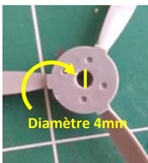
Percer le support d'hélice pour permettre le passage du tube de jonction du Moteur S (D : 4mm).
