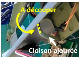
Découper une ouverture au sommet de la cloison ajourée positionnée immédiatement avant le module électronique. Cette ouverture va permettre le passage des différents câbles.
