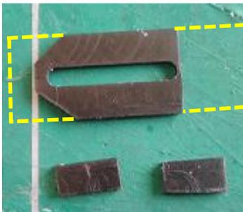
Positionner la plaque de l'actionneur au dos du support canon en intercalant une pièce coupée dans les chutes de plastique. L'espace ainsi créé entre le support canon et la plaque de l'actionneur permettra le passage de l'actionneur.
