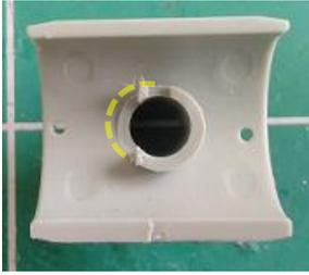
Découper la face avant du boîtier caméra afin qu'elle épouse la forme intérieure du masque canon. Vérifier le bon positionnement du boîtier caméra dans le support canon.
