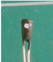
Positionner la LED dans l'encoche réalisée sur le haut de caisse puis la coller en vérifiant le bon positionnement avec le capot moteur (on peut renforcer la tenue de la LED avec de la colle cyanoacrylate type gel).
