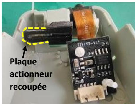
Positionner le servo et couper les tiges de l'actionneur en fonction de sa position.
