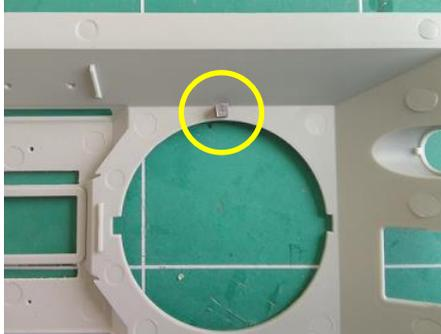
Positionner le dessus de caisse (équipé de la demi-tourelle) sur la caisse afin de mesurer la hauteur entre le plancher et la face inférieure de la plaque d'entraînement (sur ce modèle ~31.5mm).
