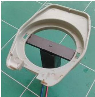
Positionner l'ensemble sur la caisse et coller le boîtier moteur sur le plancher du véhicule. Veiller particulièrement au bon positionnement de l'ensemble des pièces les unes par rapport aux autres. Attendre que la colle soit bien sèche avant de tester l'ensemble.
