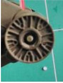
Le cache doit être collé sur l'axe de la roue mais laisser celle-ci libre. Il faut prolonger l'axe d'environ 0.5mm (entretoise coupée dans le rond plastique diamètre 2mm) pour établir une surface de contact entre l'axe et le cache.
