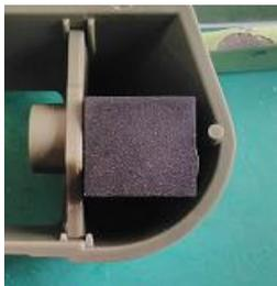
Le boîtier doit être modifié pour s'ajuster au mieux à la forme du masque et venir plaquer l'optique de la caméra dans le fond de la cavité.
