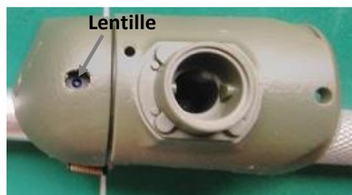
Lorsque le module optique est correctement positionné (la lentille doit être visible au travers du perçage), appliquer délicatement de la colle à la périphérie du boîtier plastique en prenant garde de ne pas en mettre sur le flex. Maintenir en position jusqu'au séchage de la colle.
