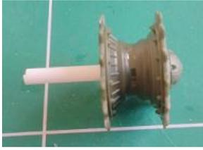
Positionner le barbotin sur la caisse et couper le tube de renfort au niveau de la surface intérieure de la caisse.
