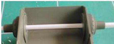
Dans du tube plastique (diamètre intérieur 3mm, diamètre extérieur 4mm), couper une bague (longueur ~5mm).
