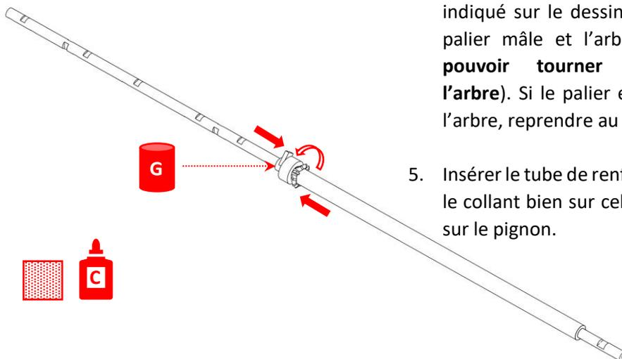
4. Mettre le palier mâle en position comme indiqué sur le dessin. Vérifier le jeu entre le palier mâle et l'arbre mâle (**le palier doit pouvoir tourner indépendamment de l'arbre**). Si le palier est monté trop serré sur l'arbre, reprendre au papier de verre.
