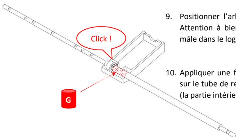
10. Appliquer une fine couche de graisse neutre sur le tube de renfort collé sur l'arbre femelle (la partie intérieure du boîtier).
