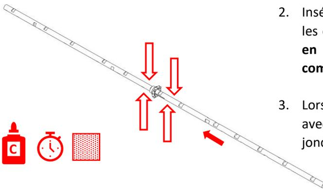
2. Insérer l'arbre femelle en faisant correspondre les épaulements en « D », **coller et maintenir en pression** (laisser en pression **une nuit complète** pour assurer un bon maintien).
