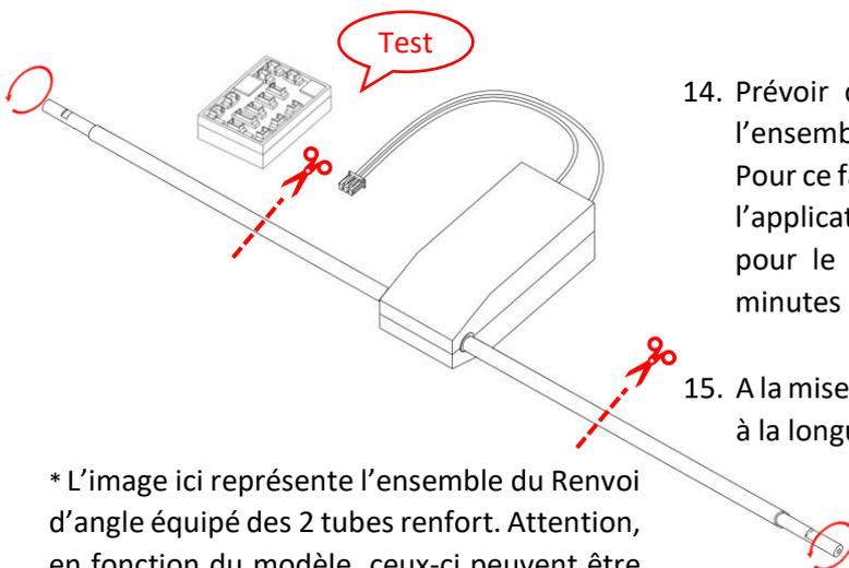
14. Prévoir quelques minutes de « rodage » de l'ensemble avant de le monter sur le modèle. Pour ce faire, brancher sur le Module et utiliser l'application du Smartphone ou de la Tablet pour le faire fonctionner pendant quelques minutes à pleine vitesse.
