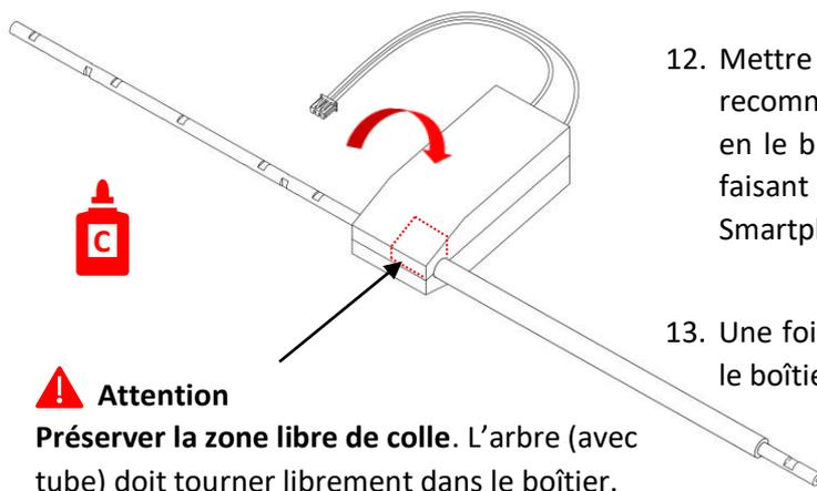
12. Mettre le boîtier supérieur en position. Il est recommandé de tester le bon fonctionnement en le branchant sur le module Wi-Fi et en faisant fonctionner via l'application de votre Smartphone ou Tablet.
