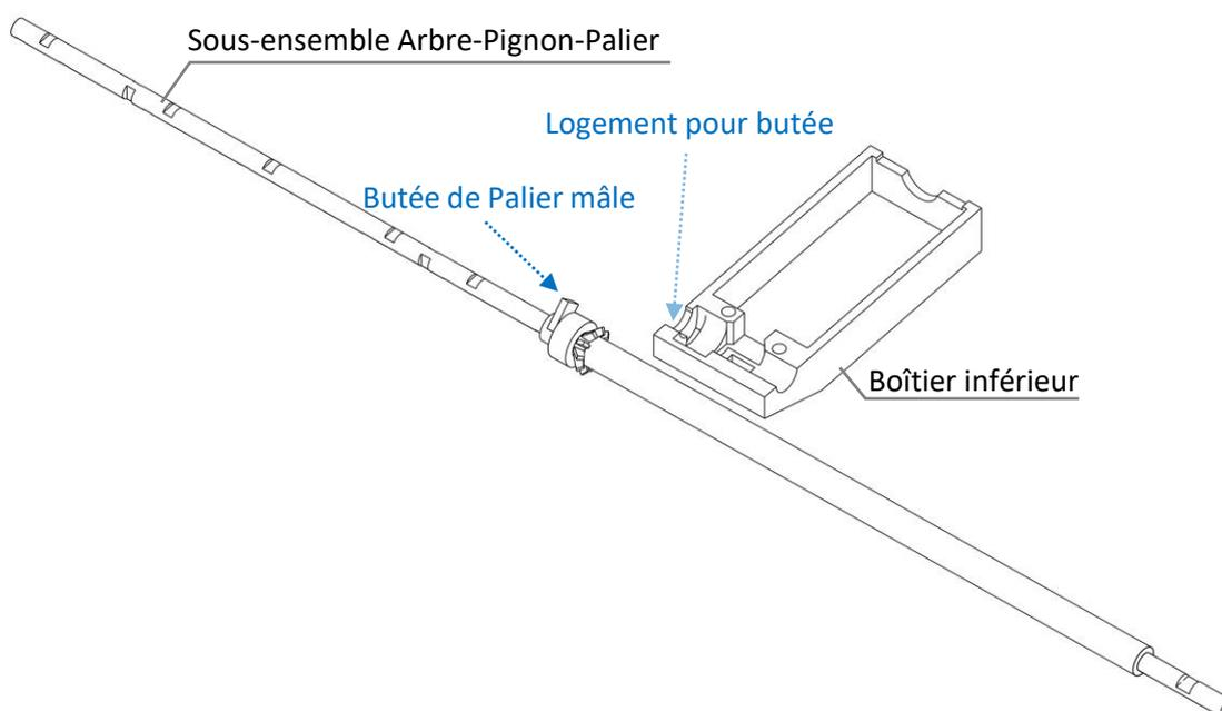
9. Positionner l'arbre dans le boîtier inférieur. Attention à bien engager la butée de palier mâle dans le logement prévu à cet effet.
